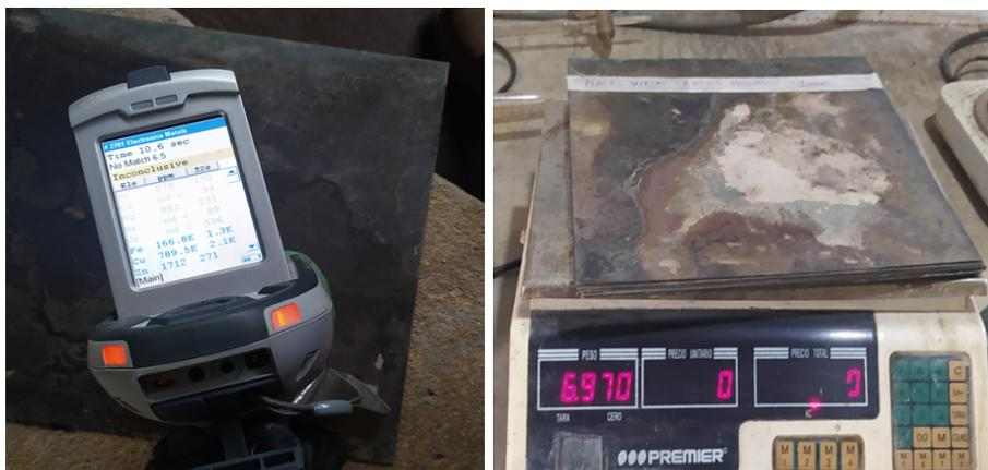
**Figura 11.** Placas de cobre saturadas de mercurio. **Fuente:** Pure Earth 2023.
