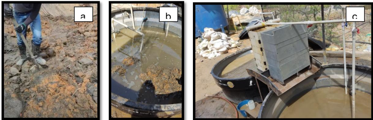
**Figura 9.** Desarrollo de las pruebas piloto. a) Cargue de material, b) preparación de la solución de pulpa de relave, c) encendido de equipos de bombeo. **Fuente:** Pure Earth, 2023.
