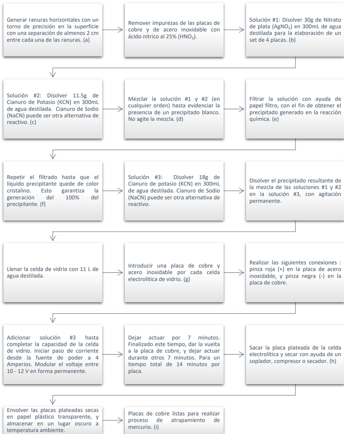
**Figura 1.** Procedimiento para la preparación de una placa de cobre. **Fuente:** Pure Earth, 2023.
